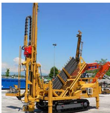
Equipo con cargador automático de varillas
