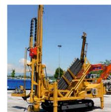
Equipo con cargador automático de varillas
